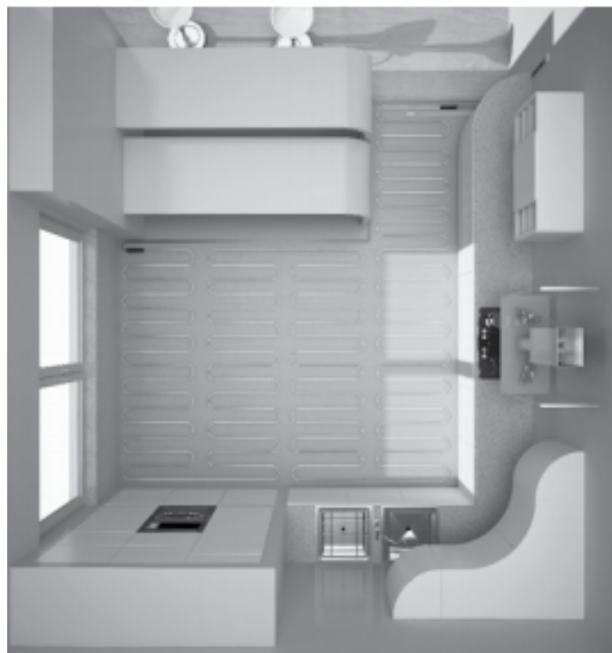
Egyéni elrendezésű fűtőszőnyeg lefektetése
